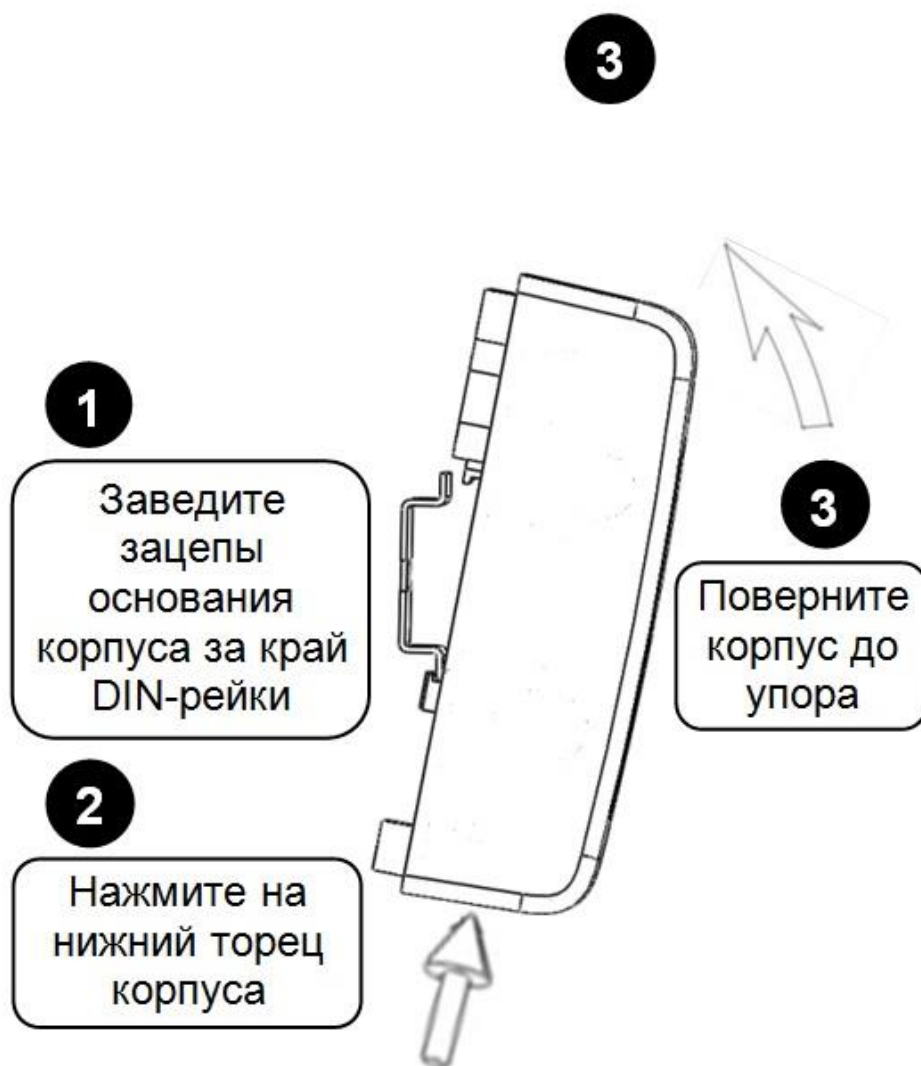
Рисунок 4. Крепление «УО-4С исп.02» на DIN-рейку
