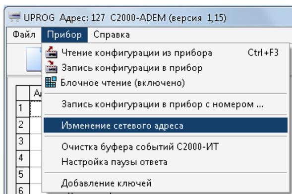
1.6.3 Для каждого ПП задаётся его физический адрес, установленный перемычками или ДИП-переключателями (соответствие адресов указано в документации на ПП). Для этого в программе «UProg» во вкладке «Устройства» задайте соответствие адресов подключённых ПП.
