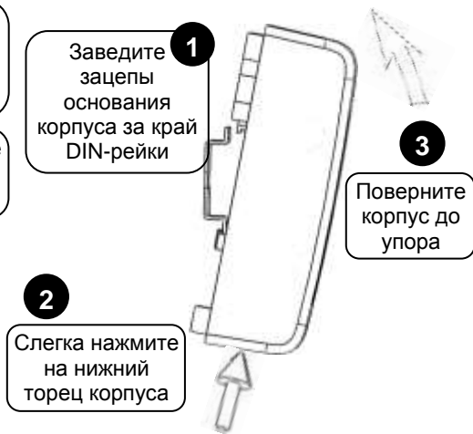
Рисунок 3. Крепление прибора на DIN-рейку
