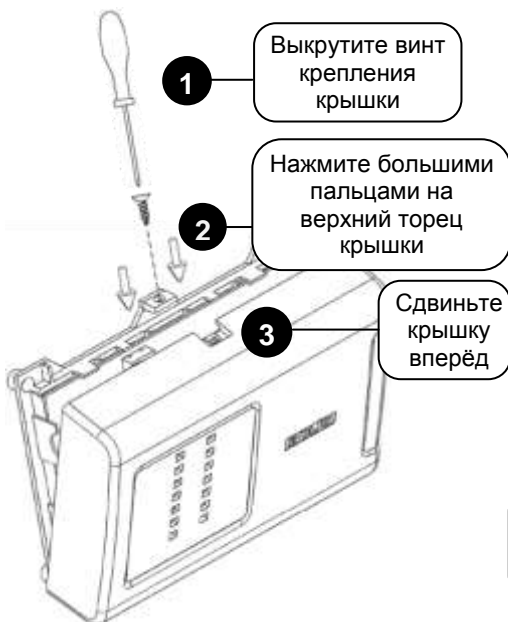
Рисунок 2. Снятие крышки прибора
