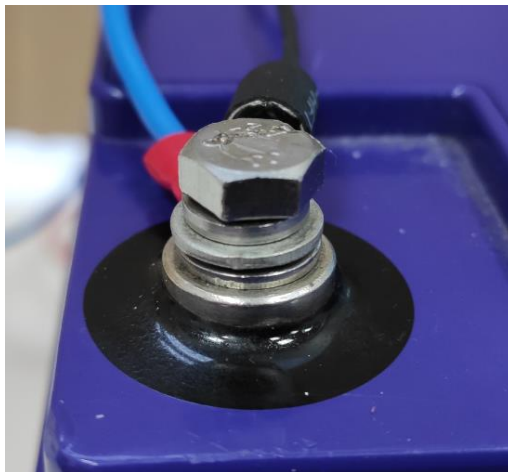
Рисунок 3. Подключение клеммы термодатчика
