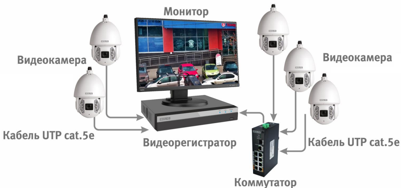
Рисунок 6.4 – Схема подключения видеокамеры к видеорегистратору
