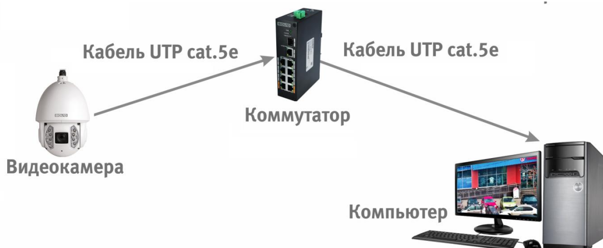
Рисунок 6.3 – Схема подключения видеокамеры к компьютеру через коммутатор
