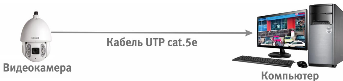
Рисунок 6.2 – Схема подключения видеокамеры к компьютеру
