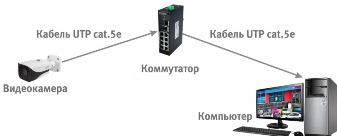
Рисунок 6.3 – Схема подключения видеокамеры к компьютеру через коммутатор
