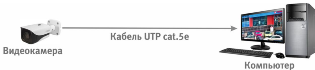
Рисунок 6.2 – Схема подключения видеокамеры к компьютеру
