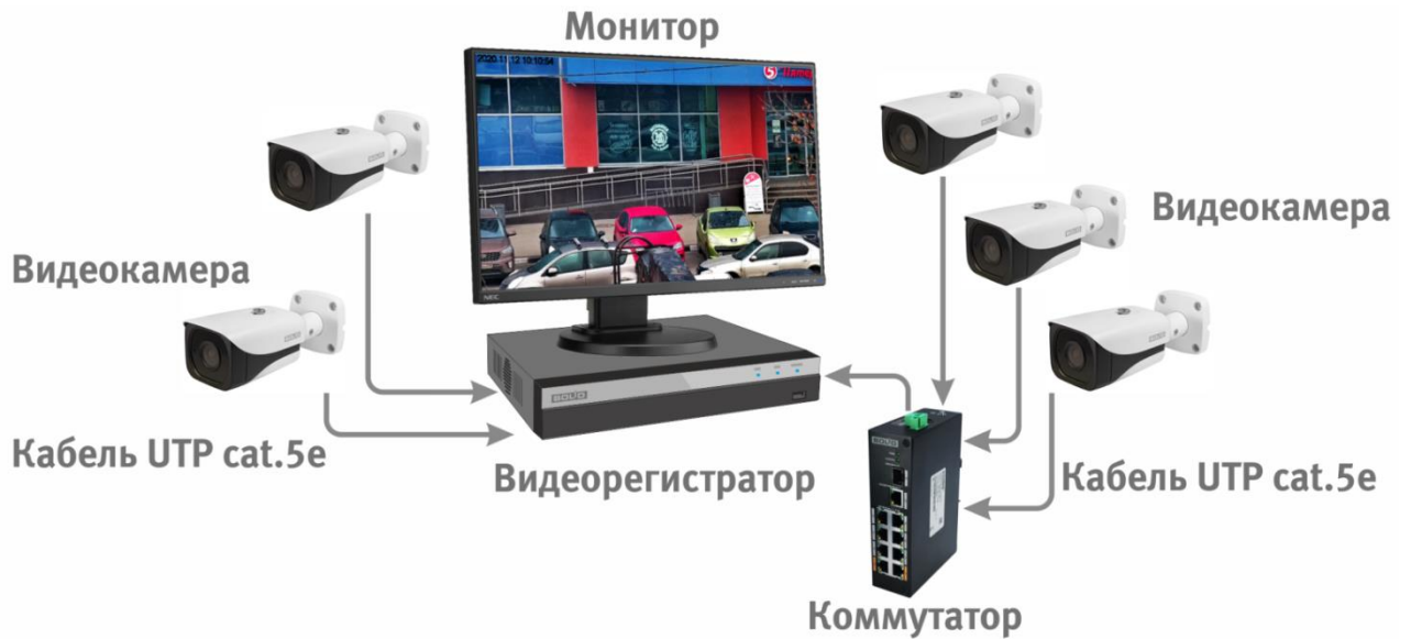
Рисунок 6.4 – Схема подключения видеокамеры к видеорегистратору
